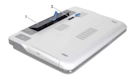
1 аккумулятор 2 защелка отсека аккумулятора
